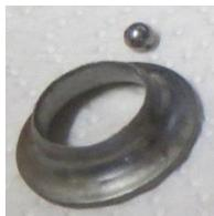
Risse im Lager Gehäuse/ Zentrierring gebrochen. **14 Kugeln**
